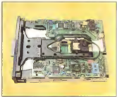
Il drive per dischetti da 5 1/4" e il processore Maratino e altri componenti inseriti nel vano di espansione
